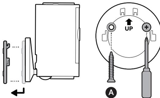
端末を取付プレートにスライドして固定します。
